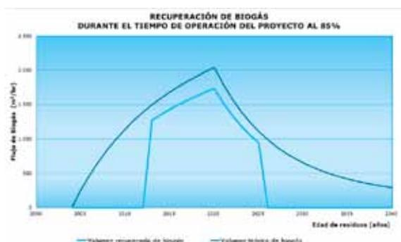
**Figura 6.2 y 6.3 Generación de Biogás teórica y recuperable 2013-2025.**
