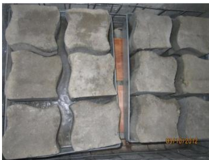
Fotografía N° 15: Losetas en la cámara congeladora
