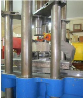
Fotografía N° 11: Colocación de la loseta en la Máquina Universal
