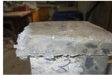
Fotografía N° 16: Loseta recién retirada de la cámara congeladora
