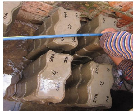
Fotografía N°7: Losetas curadas por riego
