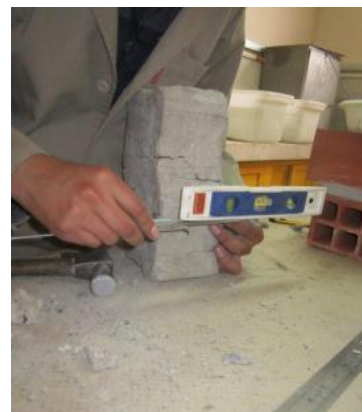
Figura N° 13: Medición de la altura de una loseta ensayada
