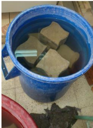
Fotografía N° 14: Losetas sumergidas para saturación
