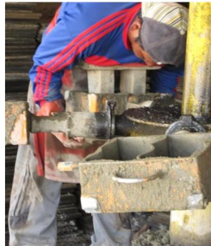
Fotografía N° 2: "pecheo" para sacar las losetas de los moldes
