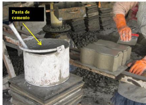
Fotografía N° 3: Acabado superficial de las losetas recién desmoldadas
