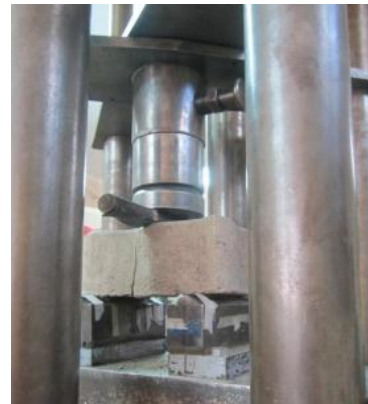
Figura N°12: Loseta sometida a flexión hasta la rotura
